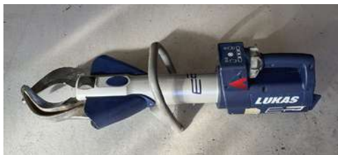
▲ Cizalla eléctrica/batería: usada para labores de corte en estructura de vehículos y labores de excarcelación principalmente.
