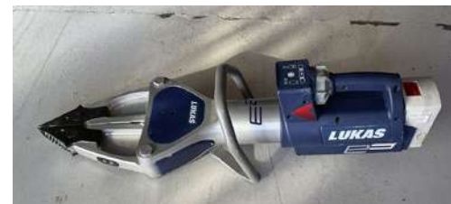
▲ Separador eléctrico/batería: usado para apertura de puertas, huecos, aplastamientos, etcétera, en tareas de excarcelación en vehículos principalmente.
